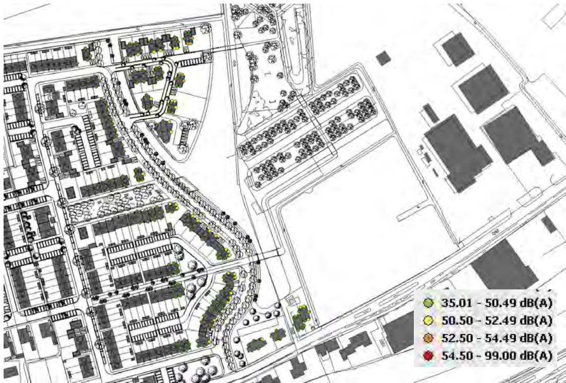
Figuur 3: Basis zonder maatregelen met weergave geluidbelasting
