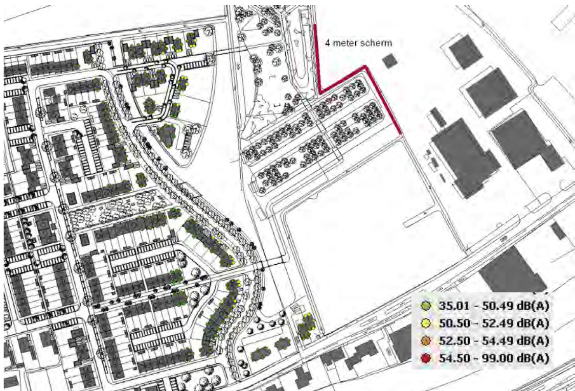
Figuur 4: Variante 2 met 4 meter hoog scherm
