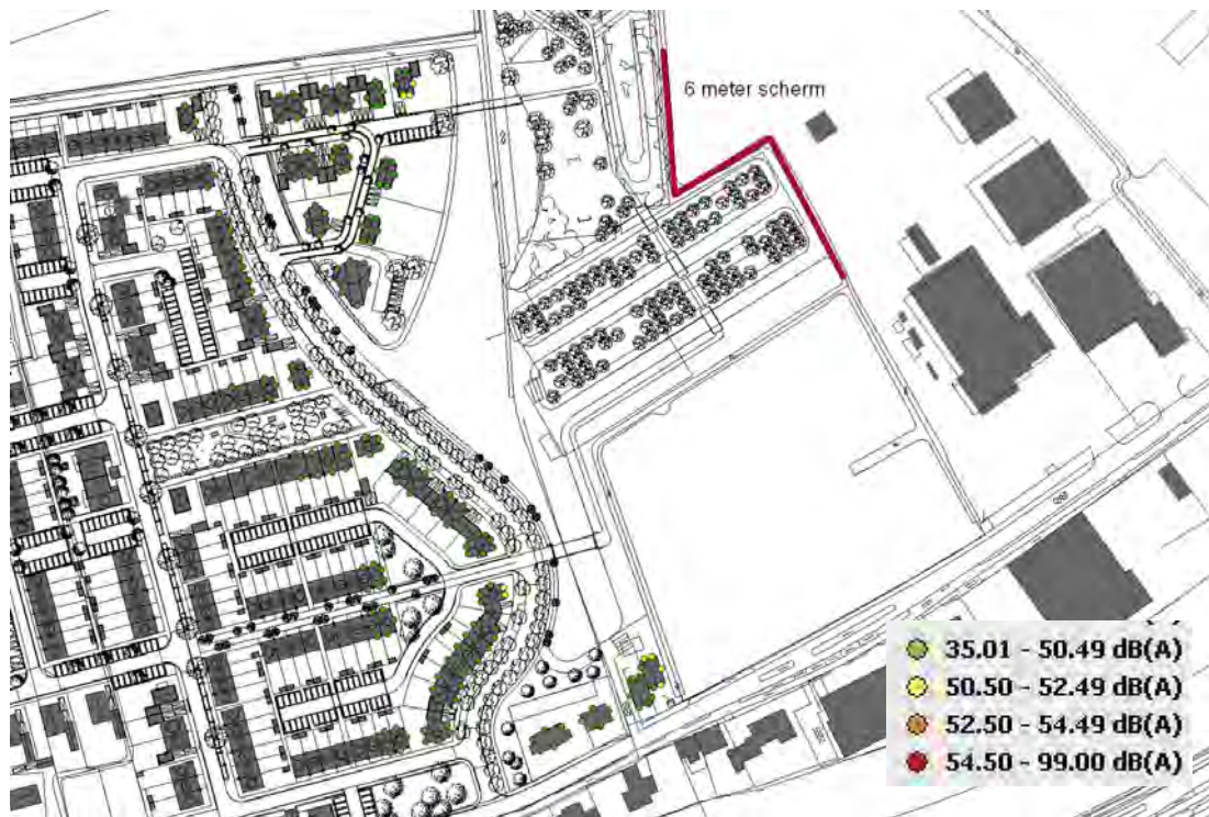
Figuur 5: Variante 2a met 6 meter hoog scherm
