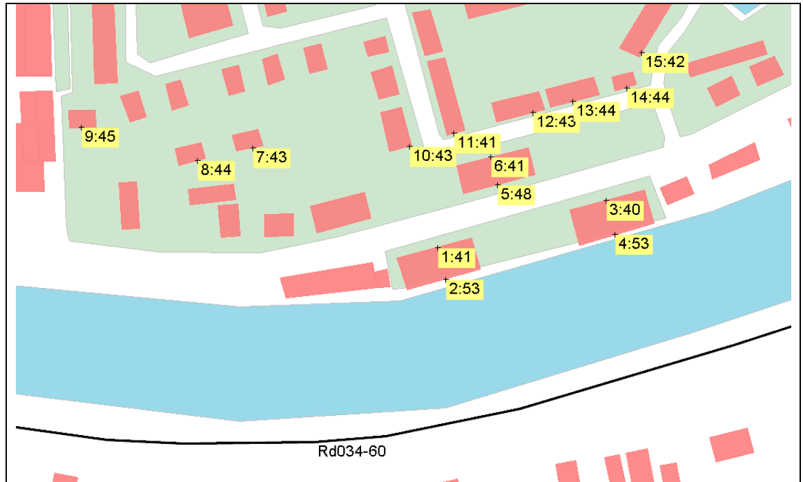
Figuur 2 Berekeningsresultaten geluidsbelasting L_{den} vanwege Rijndijk, inclusief aftrek 5 dB art. 110g Wgh.
