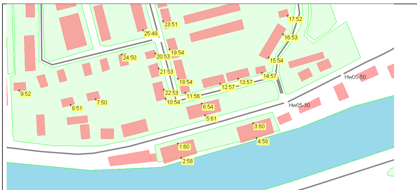
Figuur 6 Totale gecumuleerde geluidsbelasting Rijndijk, Hogewaard en interne wegen. De berekende waarden zijn exclusief aftrek art. 110g en dienen gebruikt te worden voor de bepaling van de gevelisolatie.
