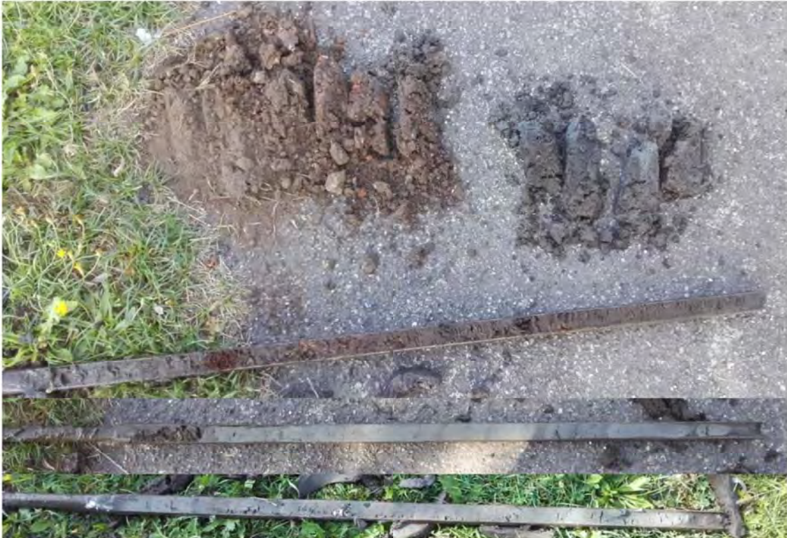
Afbeelding 4 Boring 5. Deze boring kon worden doorgezet tot een diepte van 4 meter beneden maaiveld. Tot een diepte van 120 cm beneden maaiveld is opgehoogde grond aanwezig. Daaronder is kleiig veen aanwezig tot een diepte van 210 centimeter beneden maaiveld. Onder het veen zijn kleiafzettingen van het Laagpakket van Wormer aangetroffen tot het einde van de boringen.
