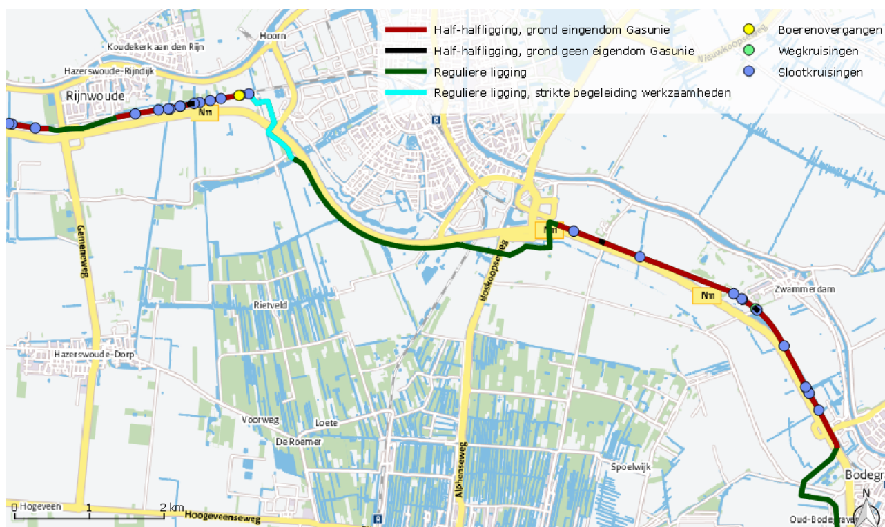
Figuur 8: Boerenovergangen, wegkruisingen, slootkruisingen en leidingdelen die niet in eigen grond van Gasunie liggen, binnen het half-half gelegen deel van de A-515. Middelste gedeelte.
