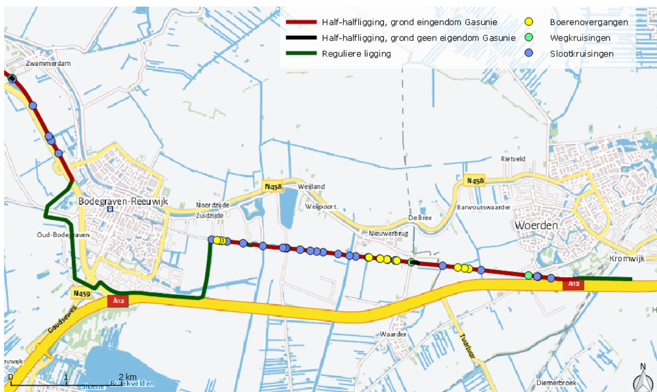
Figuur 7: Boerenovergangen, wegkruisingen, slootkruisingen en leidingdelen die niet in eigen grond van Gasunie liggen, binnen het half-half gelegen deel van de A-515. Meest oostelijke gedeelte.
