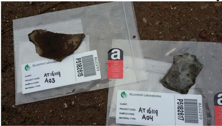
foto 037 - asbestverdacht materiaal voor analyse (A03 en A04)
