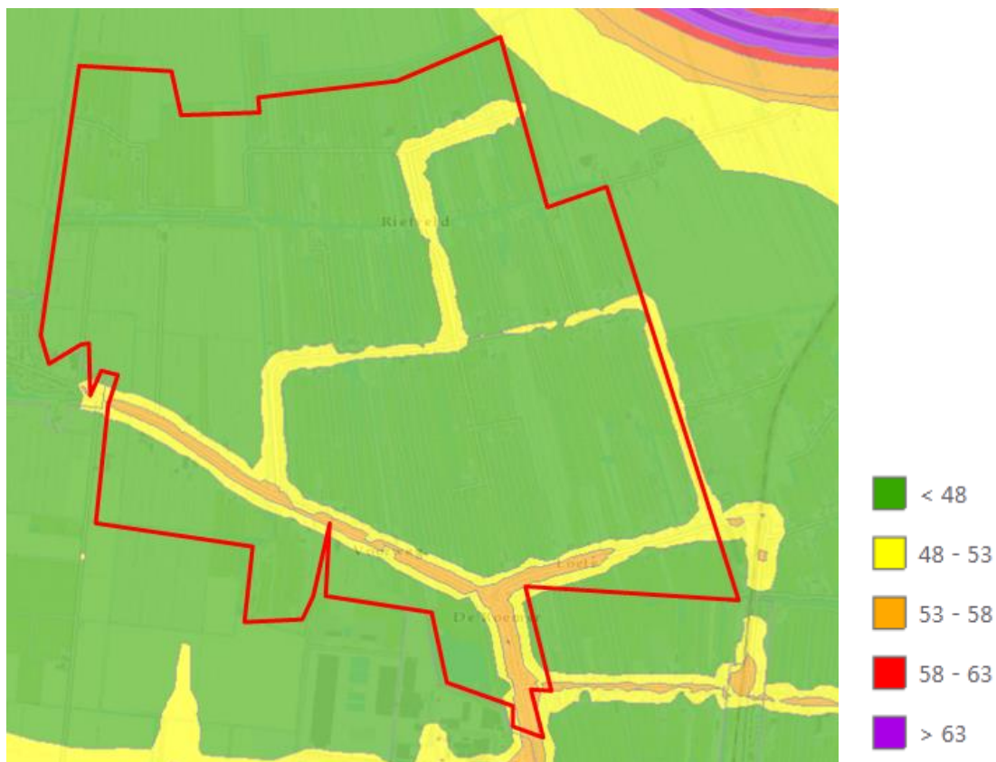
Figuur 1 Geluidscontouren wegverkeer in dB
