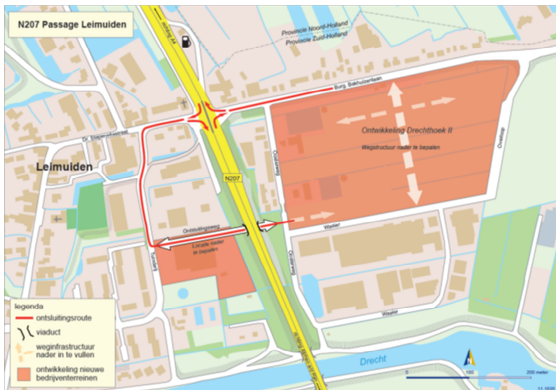
Afbeelding 10 Oplossing trajectdeel 5 Passage Leimuiden; schets Viaductvariant
