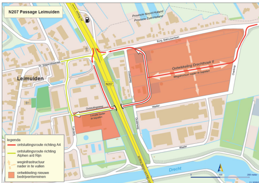
Afbeelding 11 Oplossing trajectdeel 5 Passage Leimuiden; ViaductPlusvariant
