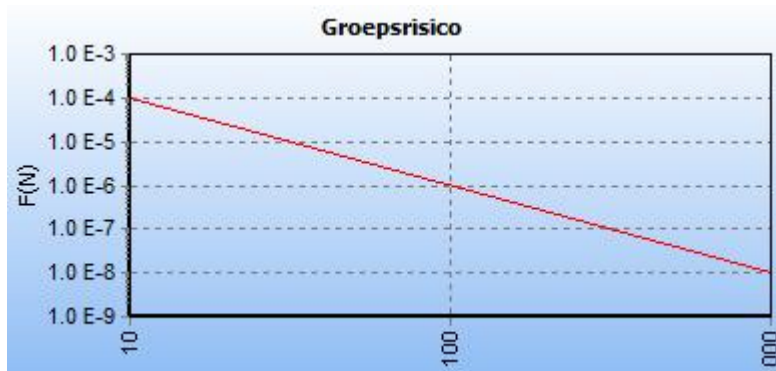
Figuur 2.9: fN-curve buisleiding A-803-deel-1, na planrealisatie
