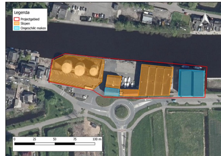
Figuur 3: aanpak zorgvuldig werken. De gebouwen zonder vleermuisverblijven worden als eerste gesloopt, waarna de overige gebouwen ongeschikt worden gemaakt (Bron luchtfoto: PDOK, 2018).
