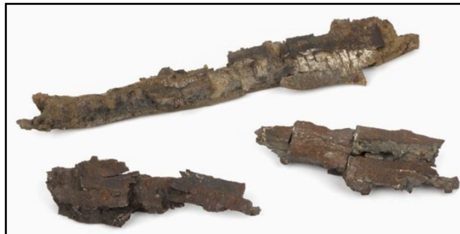
Figuur 23. Scherven afkomstig van een projectiel dat was gevuld met springstof, na detonatie.
