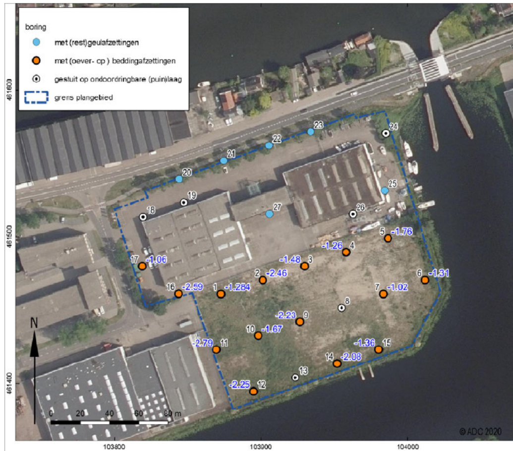
Afb 10. Resultaten booronderzoek met in blauwe cijfers de top van het bedingzand(m NAP)
