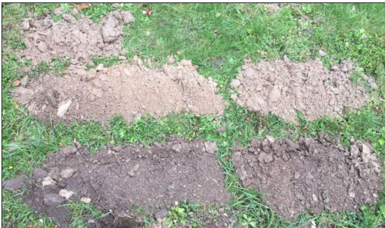
Figuur 5: Boring 2 uitgelegd van linksonder naar rechtsboven (0-270 cm –mv).
