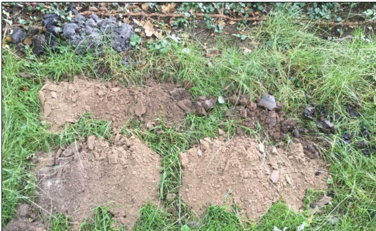
Figuur 6: Boring 6 uitgelegd van linksonder naar rechtsboven, met onderin het profiel de grijze kleiafzettingen (0-250 cm –mv).
