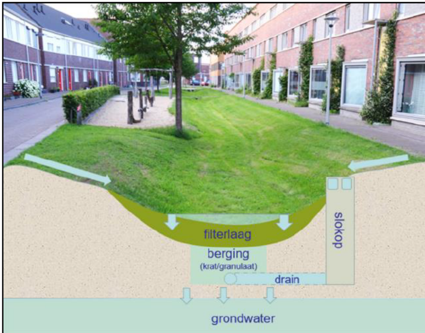
Figuur 12: Dwarsdoorsnede van een wadi. Bron: Kennisportaal Klimaatadaptatie.
