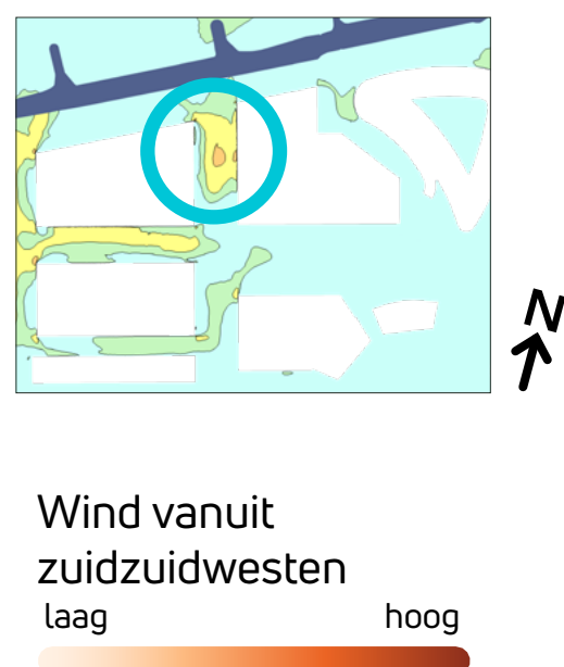
Figuur 5.2: Stroomlijnen richting de zone met windhinderklasse D in zone 3
