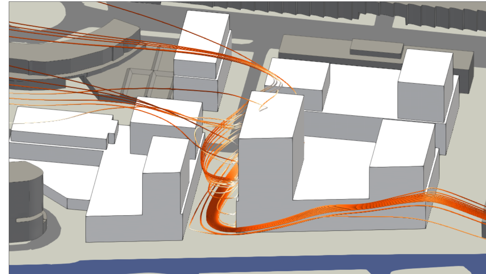
Figuur 5.1: Stroomlijnen richting de zone met windhinderklasse D in zone 3
