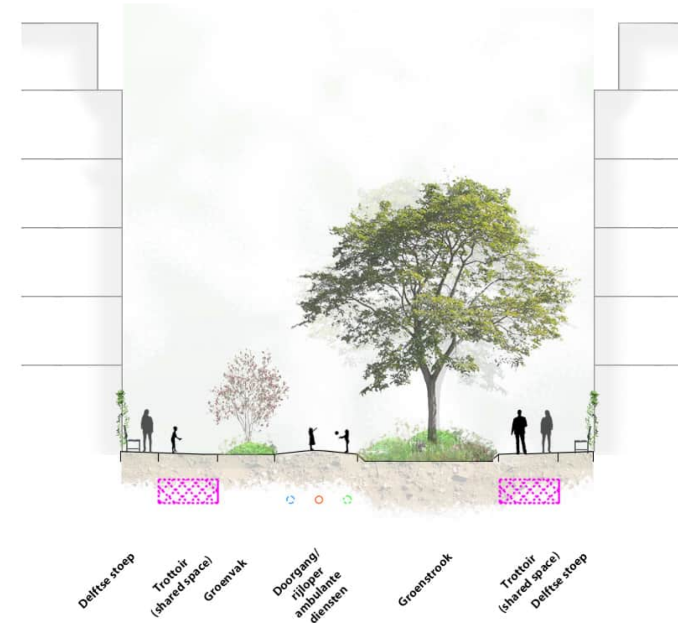
Doorsnede van de Leefstraat, opgebouwd uit aan weerszijde een trottoir en bomen in een brede groenstrook, géén parkeerplaatsen, verharding op gelijke hoogte uitzondering de groenstrook, en een rijloper voor ambulante diensten.
