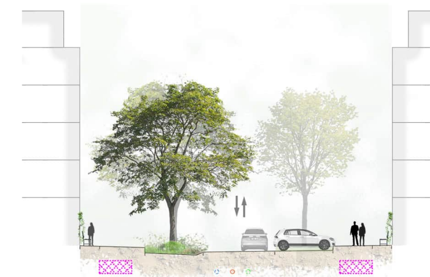
Doorsnede van de assen, opgebouwd uit een aan weerszijde trottoir en bomen in een brede groenstrook en tussen de parkeervakken, en een rijloper voor verkeer.
