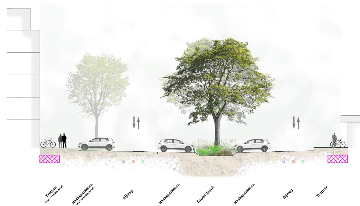
Doorsnede van de zone commercieel, een profiel opgebouwd uit aan weerszijde een trottoir, meerdere parkeerstroken, een groenstrook met lage beplanting, en ruimte voor bomen in de groenstrook en tussen de parkeervakken.
